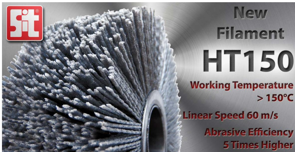
**Spazzole Sit con filo abrasivo ondulato resistente ad alta temperatura:** in particolare la tipologia HT150 è in grado di lavorare in modo continuativo alla **temperatura di 150°C** e può essere caricato con inerti abrasivi di varia specie e dimensione di grana, il più comune è carburo di silicio, materiale ceramico, noto anche come carborundum, già usato nei dischi mola e nelle carte abrasive.
